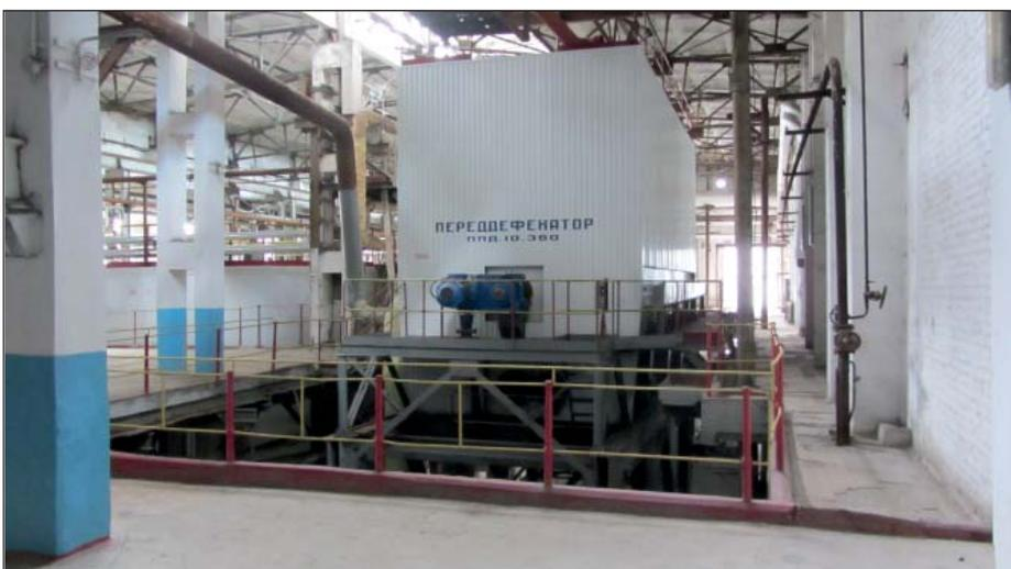
Рис. 1. Аппараты предварительной дефекации (в центре) и первой ступени основной дефекации (слева), установленные на Лохвицком сахарном заводе
